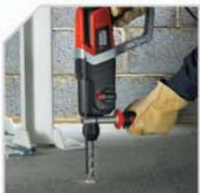
**Пневматичен чук** за пробиване в много твърди материали, като бетон.
